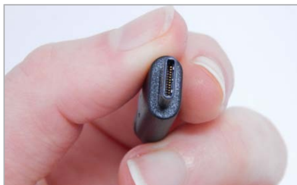
Der USB Typ C Stecker kann praktischerweise in beide Richtungen eingesteckt werden.
